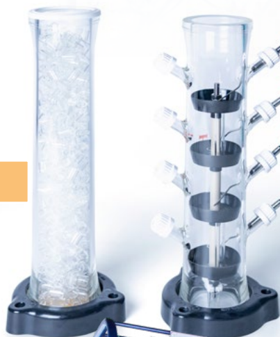
Columna de relleno Raschig / Columna de platillos de tamizado
