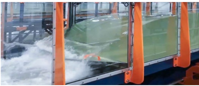
Río trenzado, acumulación de palos y sedimento de una inundación estudiados en un canal de investigación de Armfield
