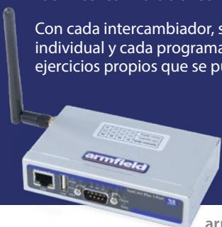
armBUS NetCan conecta hasta 20 usuarios a un solo equipo.
