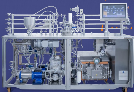
FT174 Sistema de procesamiento modular HTST/UHT a escala miniatura
