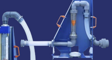
C9-MKII-9: Flujómetro de área variable con transductor
