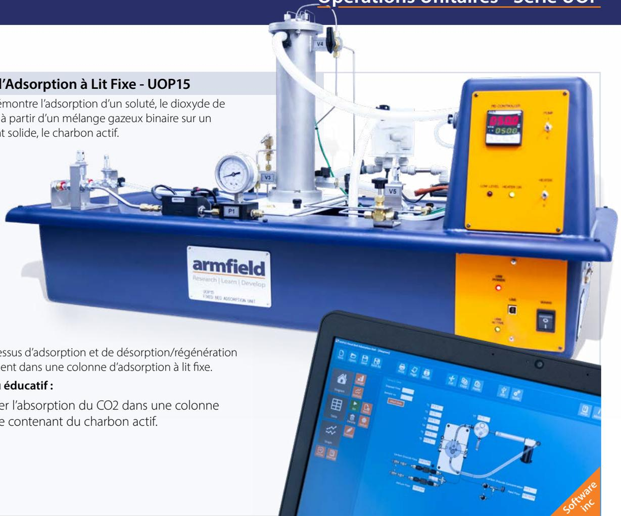
Les processus d'adsorption et de désorption/régénération se déroulent dans une colonne d'adsorption à lit fixe.
