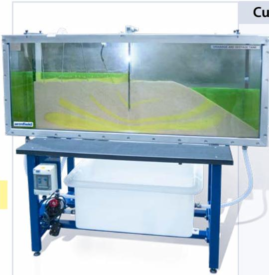
Cet appareil est conçu pour effectuer une étude exhaustive de l'écoulement à travers un milieu perméable. En utilisant du sable et les différents modèles bidimensionnels fournis, il est possible de déterminer les voies de filtration, les niveaux d'infiltration et la distribution des sous-pressions. C'est un dispositif utile pour les projets d'étudiants en génie hydrologique.
