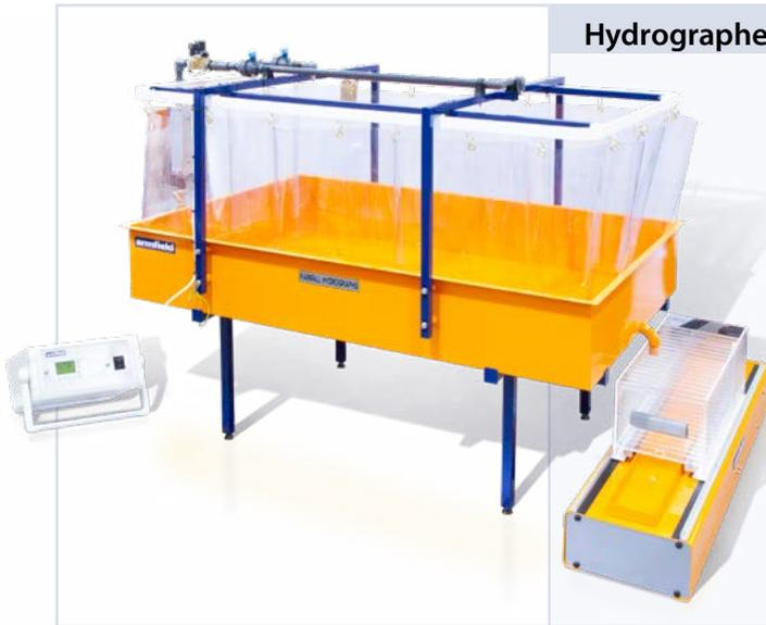
Cet appareil vise à démontrer, à petite échelle, certains des processus physiques rencontrés en hydrologie. Ces processus se divisent en deux catégories liées : la relation entre les précipitations et le ruissellement des zones de captage de perméabilité variable et l'abstraction des eaux souterraines à l'aide de puits, tant avec que sans recharge de surface due aux précipitations.
