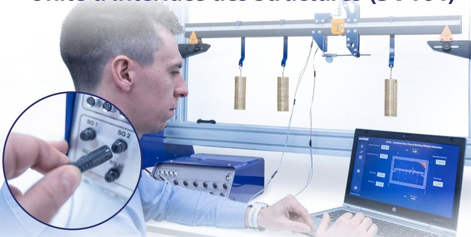
L'Armfield SV101 est une unité d'interface compacte pour la gamme de structures Armfield, qui peut être placée de manière pratique à côté de l'équipement de test. L'unité permet une intégration directe entre une expérience de structures compatible et le logiciel Armfield armBUS. La connexion à l'ordinateur de l'utilisateur se fait via la prise USB montée à l'avant.
