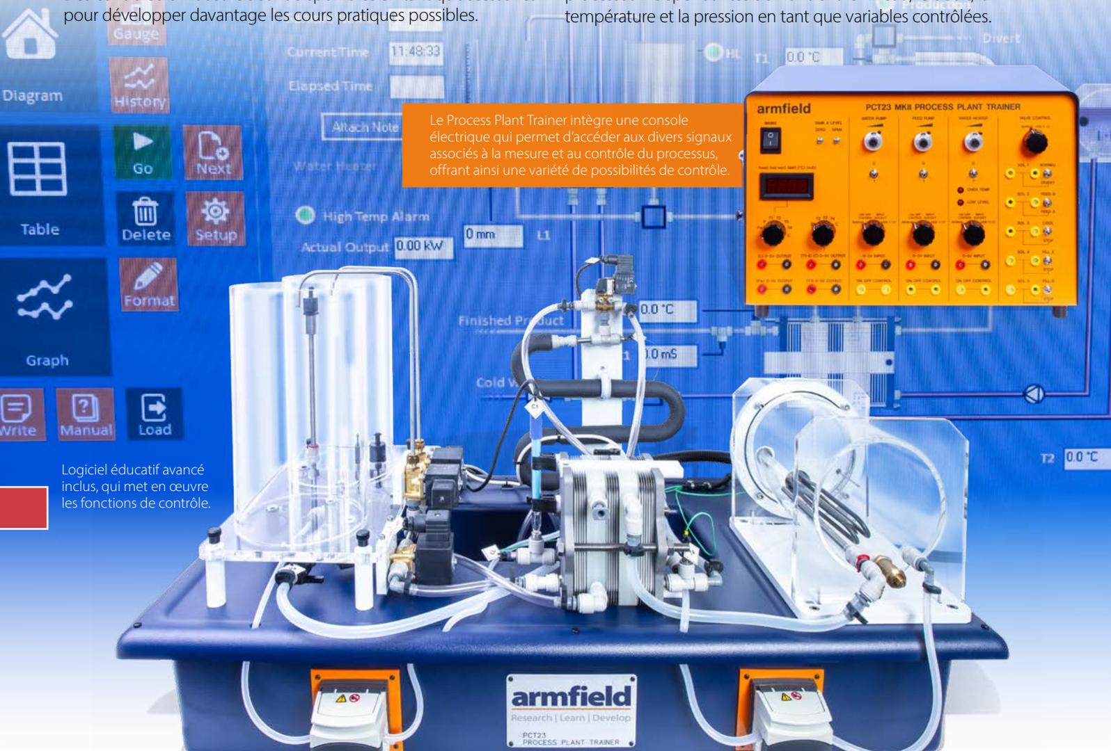
Le Process Plant Trainer intègre une console électrique qui permet d'accéder aux divers signaux associés à la mesure et au contrôle du processus, offrant ainsi une variété de possibilités de contrôle.
