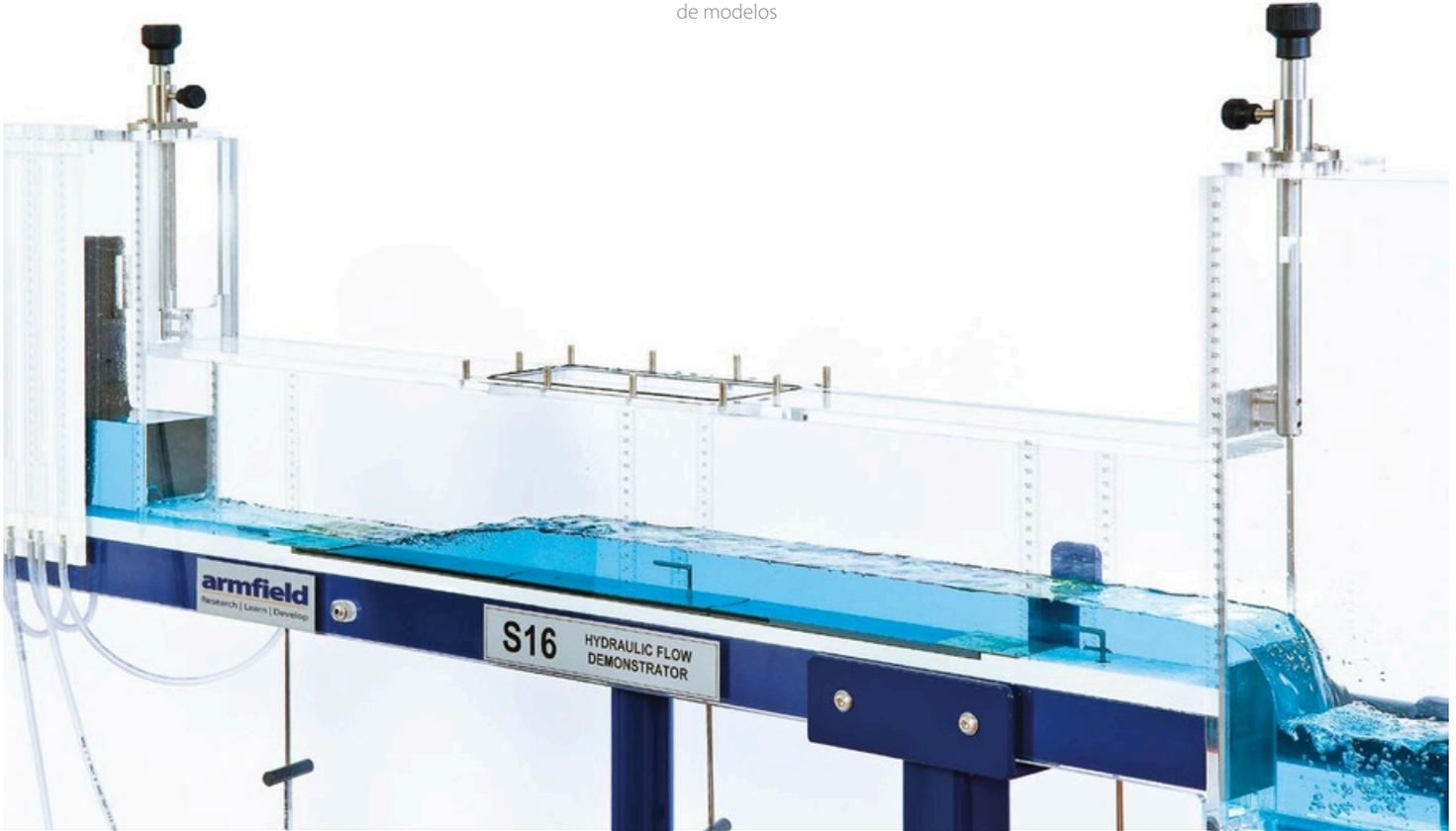
S16 configurado como canal abierto que muestra el resalto hidráulico aguas abajo de un vertedero de descarga inferior, donde la energía se disipa durante la transición de un flujo supercrítico somero a un flujo subcrítico más profundo.
