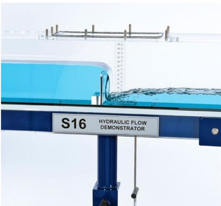
Flujo sobre un vertedero de borde agudo con la lámina (no ventilada) adherida a la cara aguas abajo.
