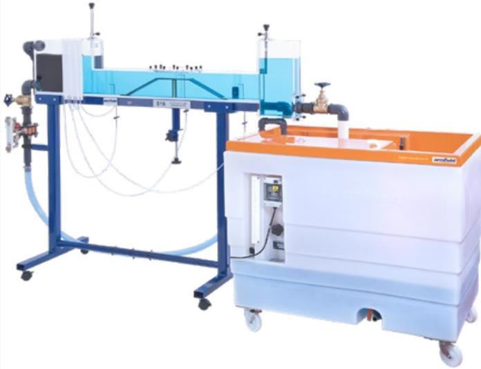
Suministrado como accesorio para el banco hidráulico F1-10/F1-10-2, el S16 puede configurarse como un conducto cerrado, mostrado con el canal elevado para formar un conducto convergente/divergente.
