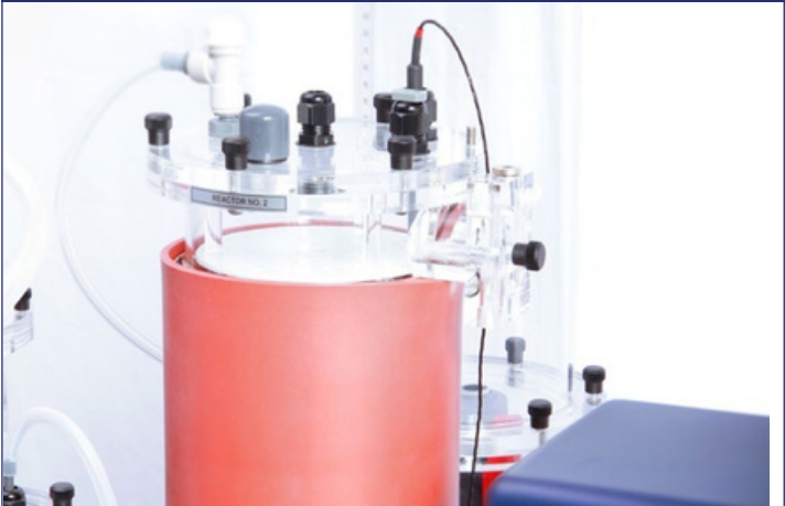
W8 Chaqueta aislante alrededor del reactor
