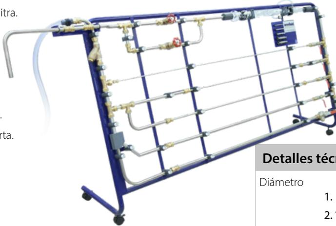
Se proporcionan muestras cortas de cada tamaño de tubo de prueba sueltas para que los alumnos puedan medir el diámetro exacto y determinar la naturaleza del acabado interno.
