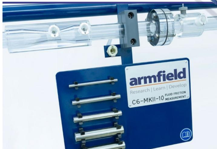
C6-MKII Muestras de tubos de ensayo, Venturi de metacrilato y placa de orificio
